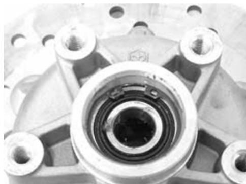
Mediante ferramenta específica remova o rolamento de esferas
