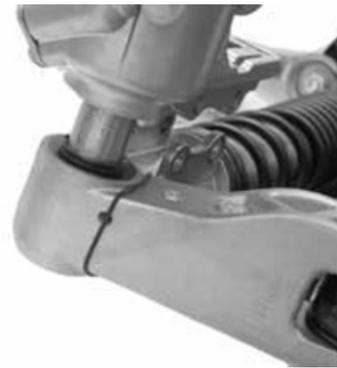
**Binários de bloqueio (N\*m)****Fixação inferior do amortecedor 20 ÷ 27****Revisão**
