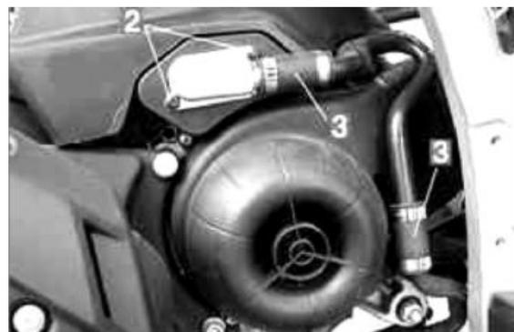
3) Afrouxe os dois parafusos de fixação (2) da tampa em alumínio da caixa de ar secundária para poder ter acesso à esponja de poliuretano contida no interior da própria caixa; realize a limpeza como no ponto 2) e remonte tudo após ter-se certificado, enquanto isso, de que a lâmina de aço não esteja deformada e/ou não garante a retenção em seu próprio plano de batente; se necessário, substitua.
