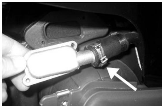
Unir devidamente o tubo de retirada de gás de escape com a junta em borracha do tubo de ar secundário. Esta junta deve garantir a hermeticidade do sistema para evitar que a leitura do valor de CO seja inexacta
