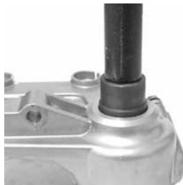
**Equipamento específico****020376Y Cabo para adaptadores****020441Y Adaptador 26 x 28 mm****020365Y Guia de 22 mm**
